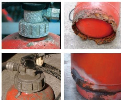
本体の腐食が進んだもの、凹みや変形したもの、ホースが脱落したものなど、老朽化した消火器の例
