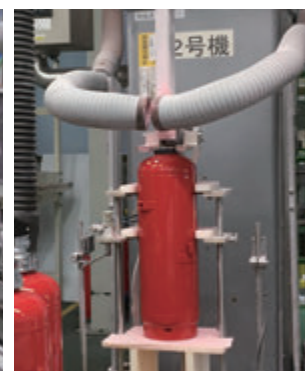
新品消火器への薬剤充填
