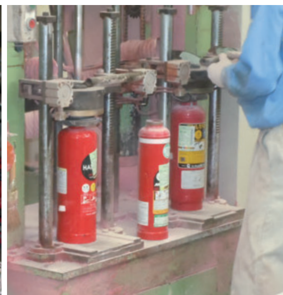
③薬剤の抜き取り
